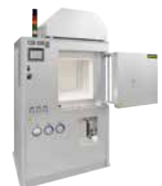
HT 160/17 DB200 для удаления вязущих присадок и спекания керамических изделий после 3D-печати
