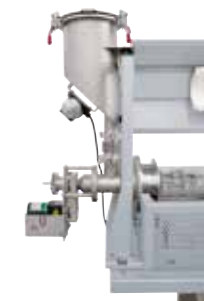
Вибрационный генератор у загрузочной воронки для оптимизации подачи порошка
