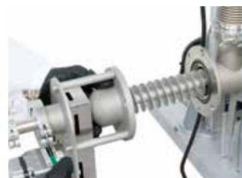
Шнековый транспортер с регулировкой скорости вращения
