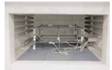
Измерительное устройство в печи для отжига
