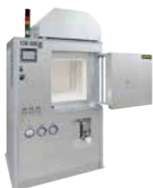
НТ 160/17 DB200 для удаления вяжущих присадок и спекания керамических изделий после 3D-печати
