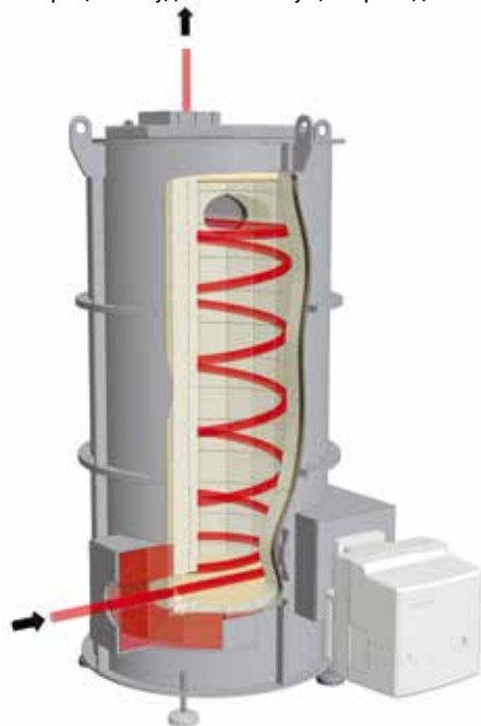
Схематическое представление системы термического дожигания (TNV)
