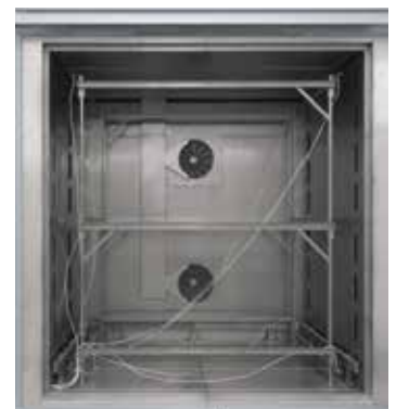
Съемная мерная стойка для конвекционной камерной печи N 7920/45 HAS
