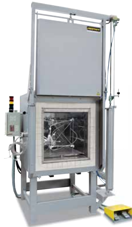
Измерительная рама для определения однородности температуры
