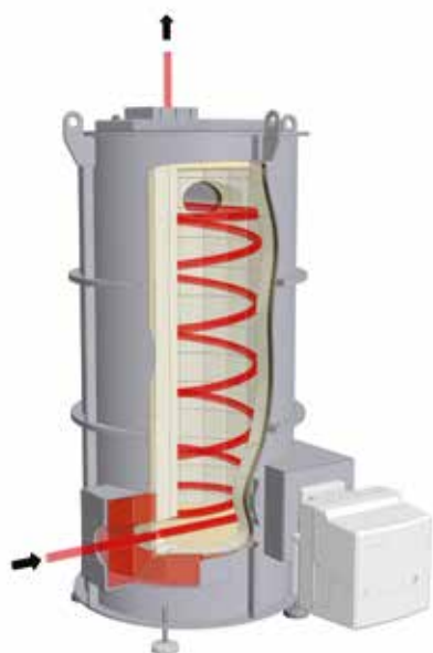
Схематическое представление системы термического дожигания (TNV)
