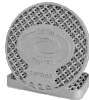
Печатная деталь из алюминия, с тепловой обработкой в модели N 250/85 HA (изготовитель CETIM CERTEC на платформе SUPCHAD)
