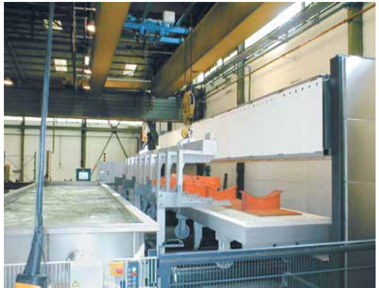
Установка для улучшения стали с ручным управлением для закалки стальных штанг, см. страницу 74/75
